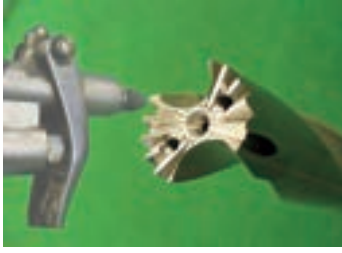
① 请取下已使用的刃头，用气流去除刀体接合部的异物。
