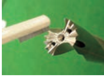
② 无法用气流去除的异物，请使用金属刷等去除。
