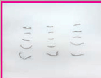
FB型ブレード FB Type Chipbreaker + T1500A
