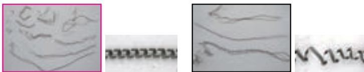
FE型断屑槽(AC8025P)
