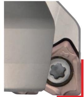
90°の切込み角により、平面削りと隅削りに適用可能
