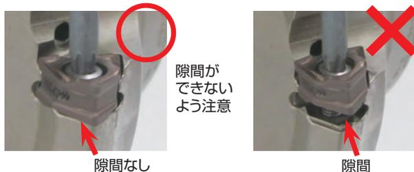
インサート座面をカッタ本体台座に密着させてから、インサート用皿ねじを推奨トルクで締め付けてください。
