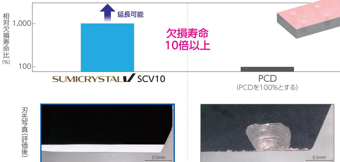
被削材：アルミニウム合金+セラミックス複合材
