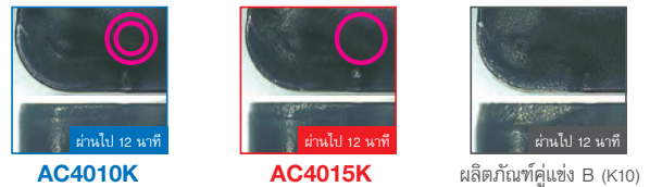
วัสดุชิ้นงาน: FCD700 ต่อเนื่อง เม็ดมีด: CNMG120408N-GZ เงื่อนไขการตัด: vc= 140 ม./นาที, f= 0.3 มม./รอบ, ap= 1.5 มม. หล่อเย็น
