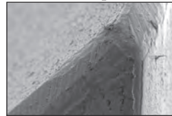
มีการแตกบิ่นที่ชั้นเคลือบผิวคมตัด
