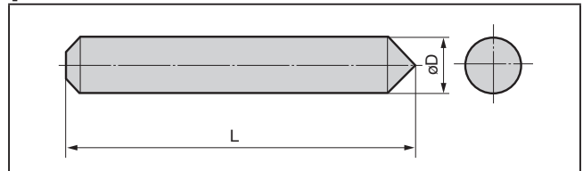
รูปทรงดอกสว่านเป่างานกลึงผิวดีบ (ตัวอย่าง)
