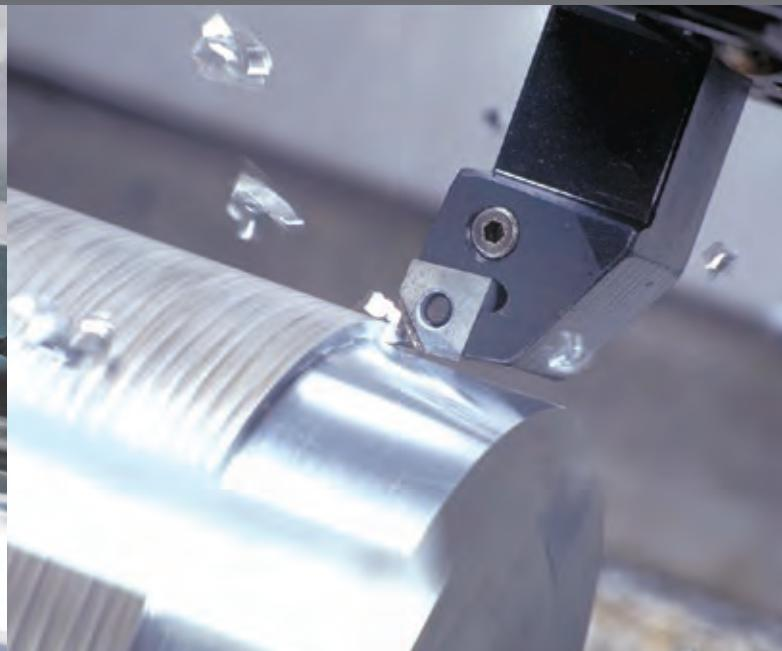
スミダイヤによるアルミニウム合金断続切削
