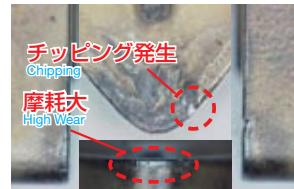
すくい面損傷進展からのチップ損傷を抑制。
