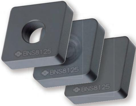
CBN粒子の粒度分布を最適化することにより、ねずみ鋳鉄加工時の高い耐摩耗性能を維持しつつ、耐欠損性能を向上、更なる長寿命化を実現
