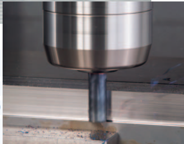
GS MILLハードラジアスによる側面加工 (SKD61)
