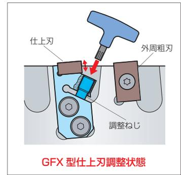
仕上刃は調整ねじを回すだけの簡単操作で5μm以下の振れ調整が可能。
