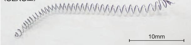
被削材: SUS304 内径加工 インサート: ECEM 03X102L-FYF(AC1030U)
