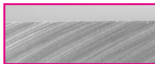
スミクリスタル(単結晶ダイヤモンド) SC10ワイパーチップの加工面
