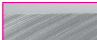
スミクリスタル(単結晶ダイヤモンド)SC10ワイパーインサートの加工面
