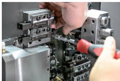
の密着性を高めることでびびりのない加工を可能にしました。また、いわゆる「おにぎり形状」のためX軸、Y軸、Z軸どの方向でも精度が高く、交換繰り返し精度は5 $\mu$ m以内を実現しました。
