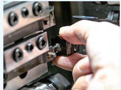
時間の短縮とスキルレスの作業に寄与するのが、住友電工の新製品「小型・自動旋盤用工具 ヘッド交換式クイックチェンジホルダ APM型」です。(詳細はP08-P09をご覧ください。)
