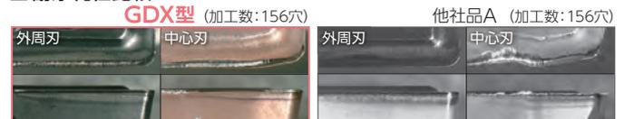
被削材:S50C 工具:GDYH200D5S25-06( $\phi$ 20, 5D)
